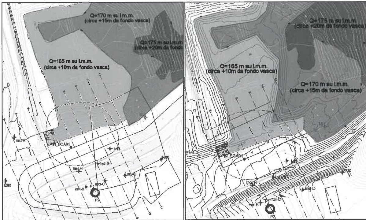
Figura 6 – Rilievo plano-altimetrico della discarica al 24-05-2020 (a sx) e al 06-09-2020 (a dx)
